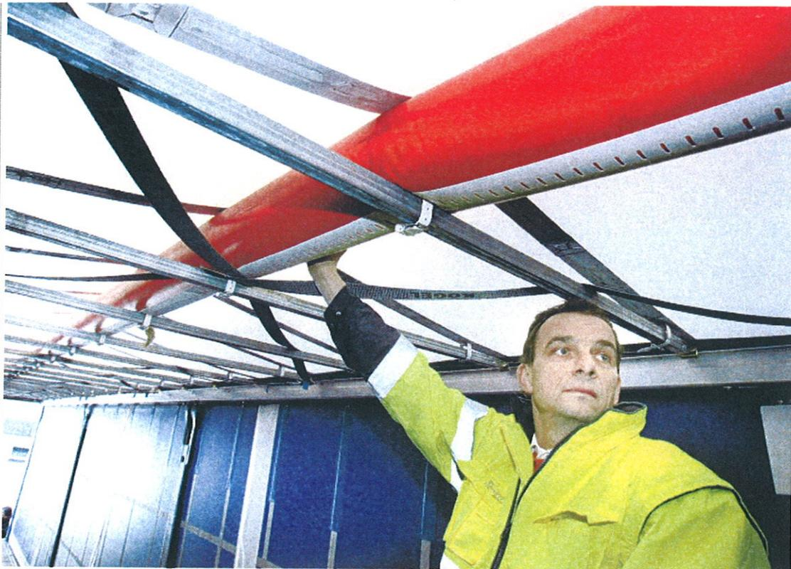
**Rettender Schlauch:** Wellogistik-Werkstattleiter Thomas Bartels hat per Knopfdruck den Dach-Airbag in Betrieb gesetzt. Die Luft drückt die Dachplane 18 Zentimeter in die Höhe. Wasser läuft ab – so kann sich kein Eis bilden.
